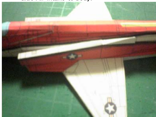
⑰. エアインテイクを機体につける。 Glue Air intake to body.
